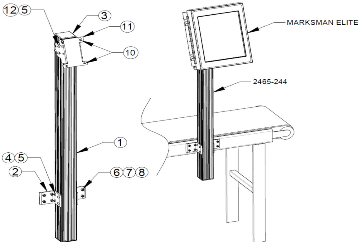
Для крепления стойки к боковой части конвейера используются компоненты 6, 7, 8 и 9.
